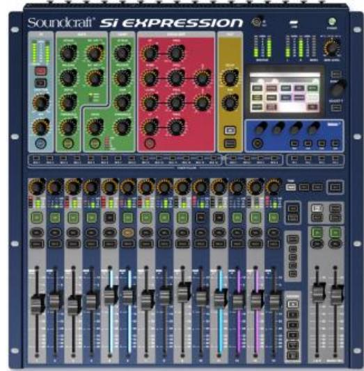
Mischpult, 56 Mono-, 6 Stereokanäle, 16 Mikrofonvorverstärker, 8 Mono-, 4 Stereo-AUX, 4 Lexicon Effektgeräte, 4 Mutegruppen, 19" Format
