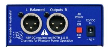
Die Blue DI Box bindet Laptops, Handys und Tablets einfach und problemfrei kabellos in eine echte Pro Audio Umgebung ein. Die Blue DI benötigt Phantomspeisung auf beiden Kanälen oder ein Netzteil.
