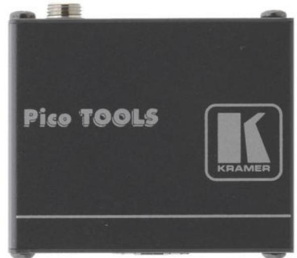
PT-571 ist ein DGKat? Twisted Pair Übertrager für HDMI-Signale. Der PT-571 konvertiert das HDMI-Signal in ein Twisted Pair Signal und überträgt dieses über eine einzelne Twisted Pair Leitung an einen kompatiblen Empfänger z.B. PT-572 oder PT-572+. Der Empfänger wandelt das eingehende Twisted Pair Signal zurück in ein HDMI-Signal.
