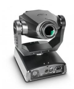
Der kopfbewegte Scheinwerfer Cameo CLMHRGB60W ist mit einer effizienten ultrahellen weißen 60 Watt LED bestückt. Er lässt sich in DMX-Modi mit 8- bzw. 13 Kanälen ansteuern oder alternativ als Einzelgerät programm- oder musikgesteuert betreiben. Ein LED-Display sowie die Steuertasten Mode, Value Up und Value Down sorgen für eine einfache Bedienung.
