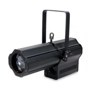
Der ADJ Encore Profile 1000 WW ist ein DMX-gesteuerter Profilscheinwerfer mit einer 100W warmweißen COB-LED mit Dimmer- und Stroboskopfunktion, einstellbarem Zoom, 4 Shutter-Blechen sowie 3- und 5-poligen DMX Ein- und Ausgängen.
