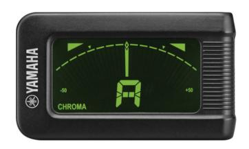
Auto Tuner mit Vibrationssensor Modes für Gitarre, Bass, Ukulele und Chromatic Stimmbereich zwischen A0-C8
